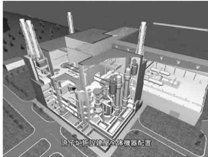
ナトリウム冷却炉の原子炉施設鳥瞰図 (150万kWe大型炉ツインプラント)
