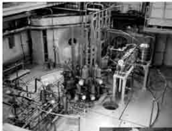
試験体 (燃料チャンバと排出ダクト)
